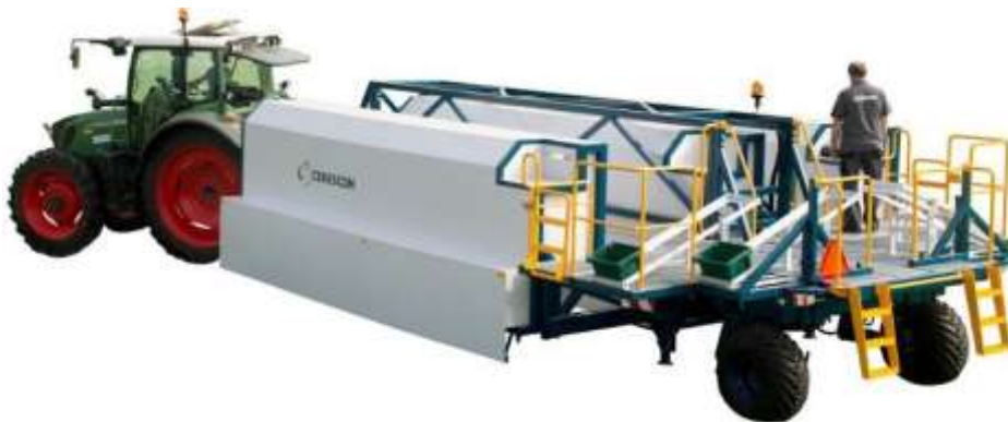
Beta versie van de eerste selectieve aspergeoogstmachine
