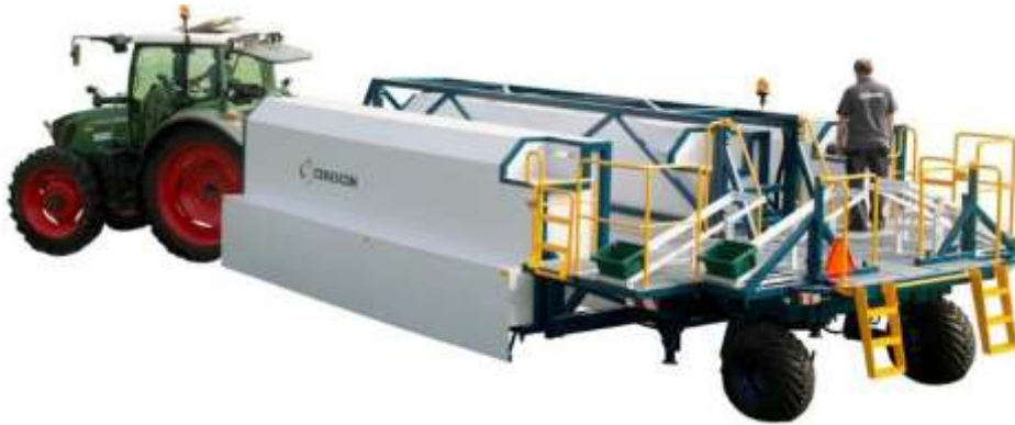
Beta versie van de eerste selectieve asperge oogstmachine
