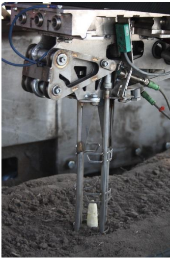
Detailfoto 1: asperge knipmes van Sparter, de oogstrobot van Cerescon
