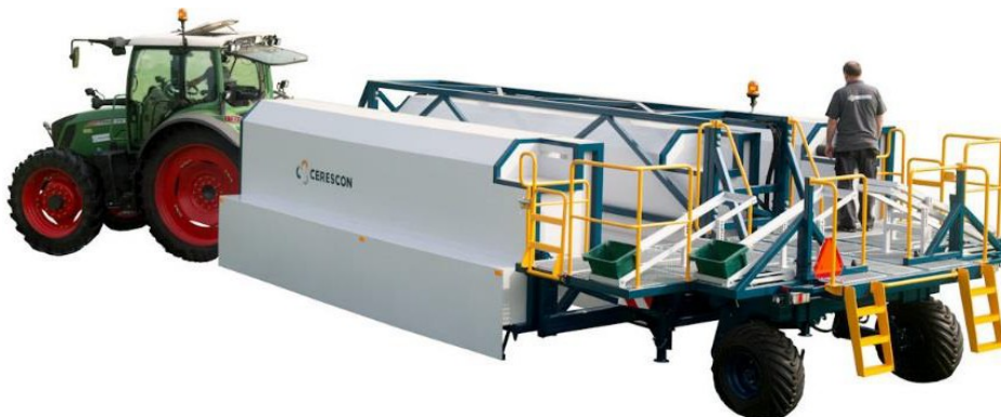
Beta versie van de eerste selectieve aspergeoogstmachine
