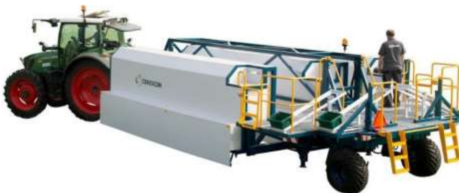
Beta versie van de eerste selectieve aspergeoogstmachine
