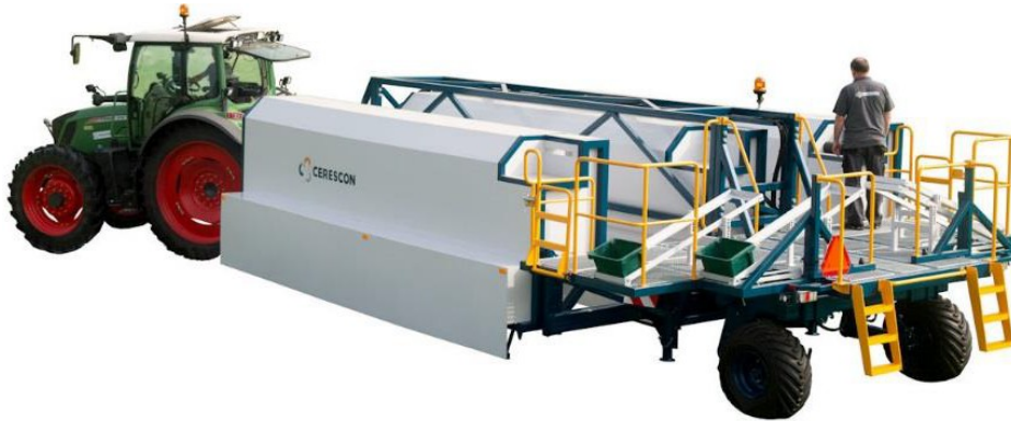
Beta versie van de eerste selectieve aspergeoogstmachine
